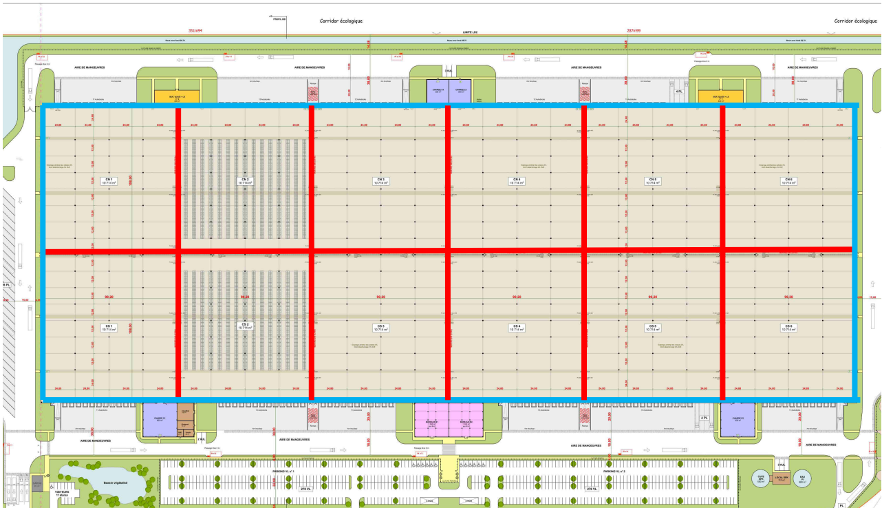
Figure 16 : Murs séparatifs et façades retenus dans FLUMILOG
